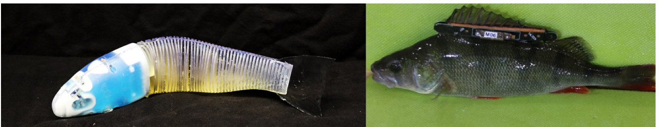
Fertigungsstudie eines Prototypen des Roboterfisches & Flussbarsch mit Rucksacksensor
